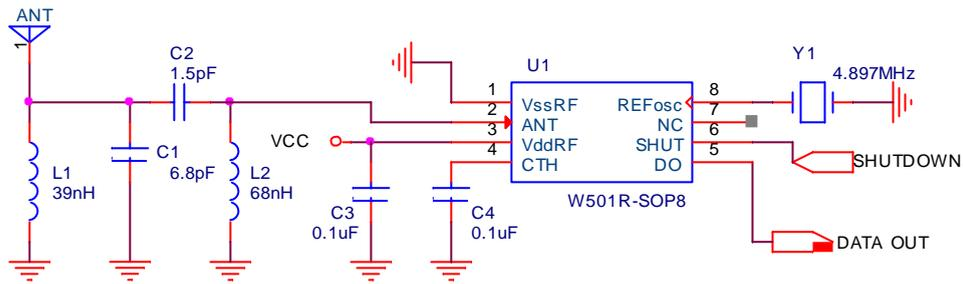
图 1 315MHz 1.5kbps 典型电路
