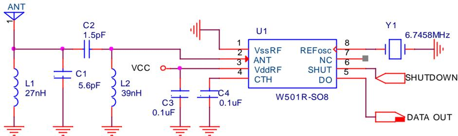
图 2 433.92MHz 1.5kbps 典型电路
