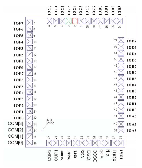
■ 注: 采用 OTP 芯片做样机制作 PCB 时,请将如下烧碌脚 RSTB, VSS, VDD, XOUT, IOA5, IOA6 共 6 根脚预留出来,以便烧碌程序用。
