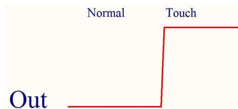
如若芯片受触发后输出端跳变为高电平，则正常跳变电压为供电电压。
